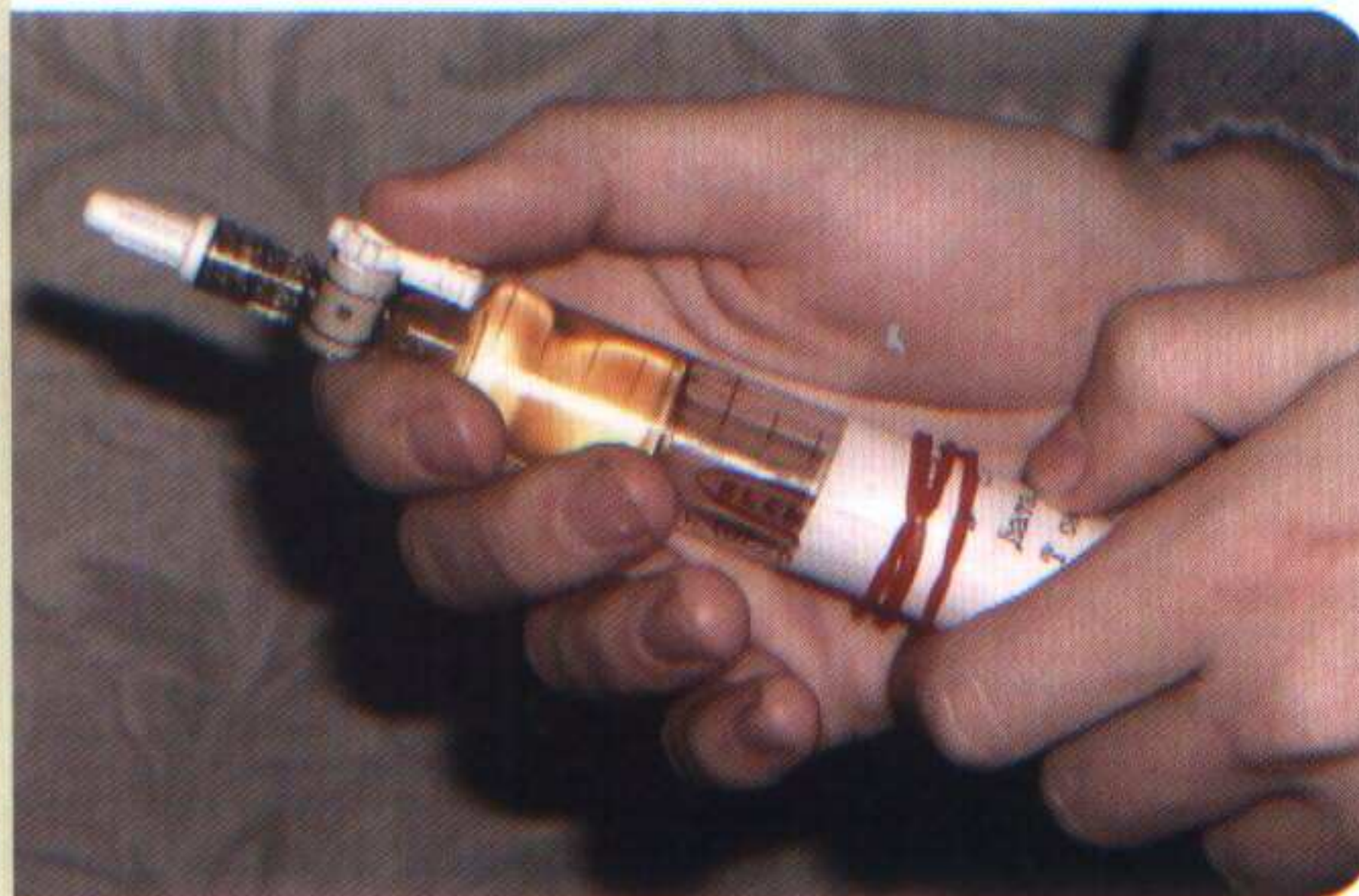
Шприцы для отбора проб масла фирмы «Элхром» с герметичным затвором
