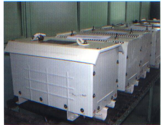
Трансформаторы в каплезащитном исполнении мощностью 400 (вверху), 63 и 16 кВА (внизу) Dripproof three-phase transformers 400 kVA (above) 63 kVA and 16 kVA (lower)
