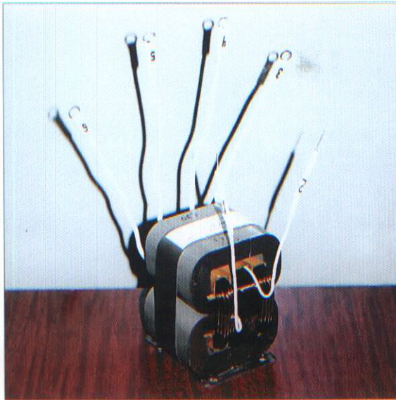
Однофазный трансформатор с отводами, выполненными собственным проводом Single-phase transformer with taps made of winding leads
