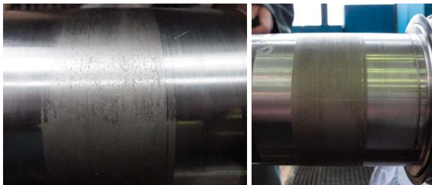
Фото 9. Электроискровой износ шеек ротора
