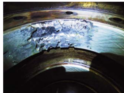
☉ Фото 3. Электроэрозионное выплавление (выкрашивание) баббита на верхних вкладышах втулочного подшипника с «лимонной» расточкой
