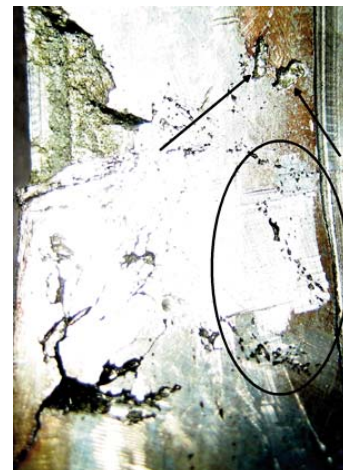
☉ Фото 4. Повреждение баббитовой заливки подшипника в виде каверн
