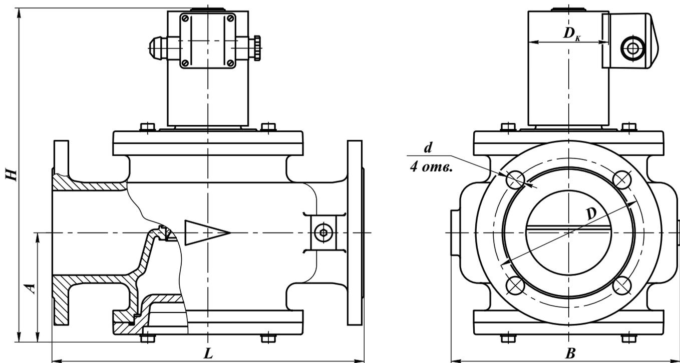
Рис. 20-7. Клапаны с ручным взводом электрического типа на DN 32 - 100 фланцевые в стальном корпусе
