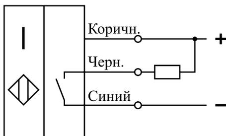
*Схема подключения индуктивной нагрузки*
